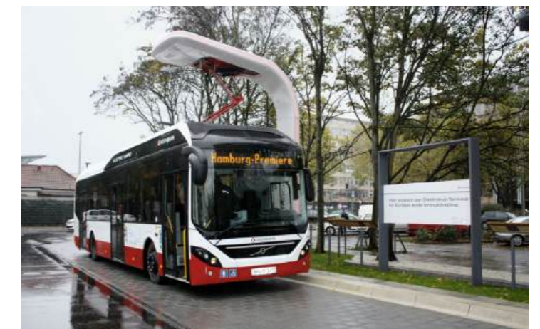
Borne de rechargement pour bus à propulsion alternative
